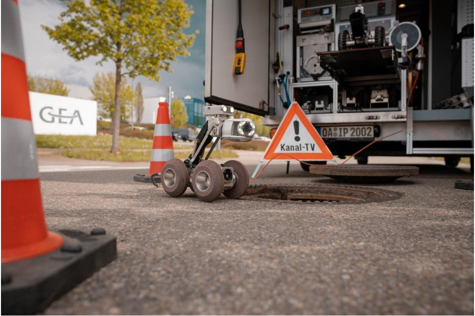
Fahrwagen für die mobile Inspektion von Abwasserkanälen
