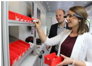
Nebenan kommissioniert der Besucher Bauteile mithilfe einer Augmented Reality-Brille. Diese blendet Informationen zu Fach und Anzahl im Blickfeld des Kommissionierers ein. Die Quittierung durch das Scannen eines Barcodes meldet dem System, dass ein Artikel aus dem Lagerfach entnommen wurde. Dies vereinfacht den Kommissionierprozess und bildet ihn durchgängig im ERP- und MES-System ab. So wird kundenindividuelle Produktion möglich und die Prozessqualität erhöht!
