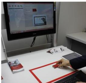
Da ist etwa der „Schlaue Klaus“: Das kamerabasierte Assistenzsystem identifiziert und kontrolliert Bauteile, zeigt dem Mitarbeiter auftragsspezifische Montageanleitungen an und überprüft und dokumentiert die Arbeitsschritte. Gerade bei unterschiedlichen Produktvarianten vereinfacht das die Arbeit, spart Zeit und erhöht die Qualität. Die Besucher bauen im Truck individuelle Streichholzschachteln mithilfe des Schlaunen Klaus zusammen.
