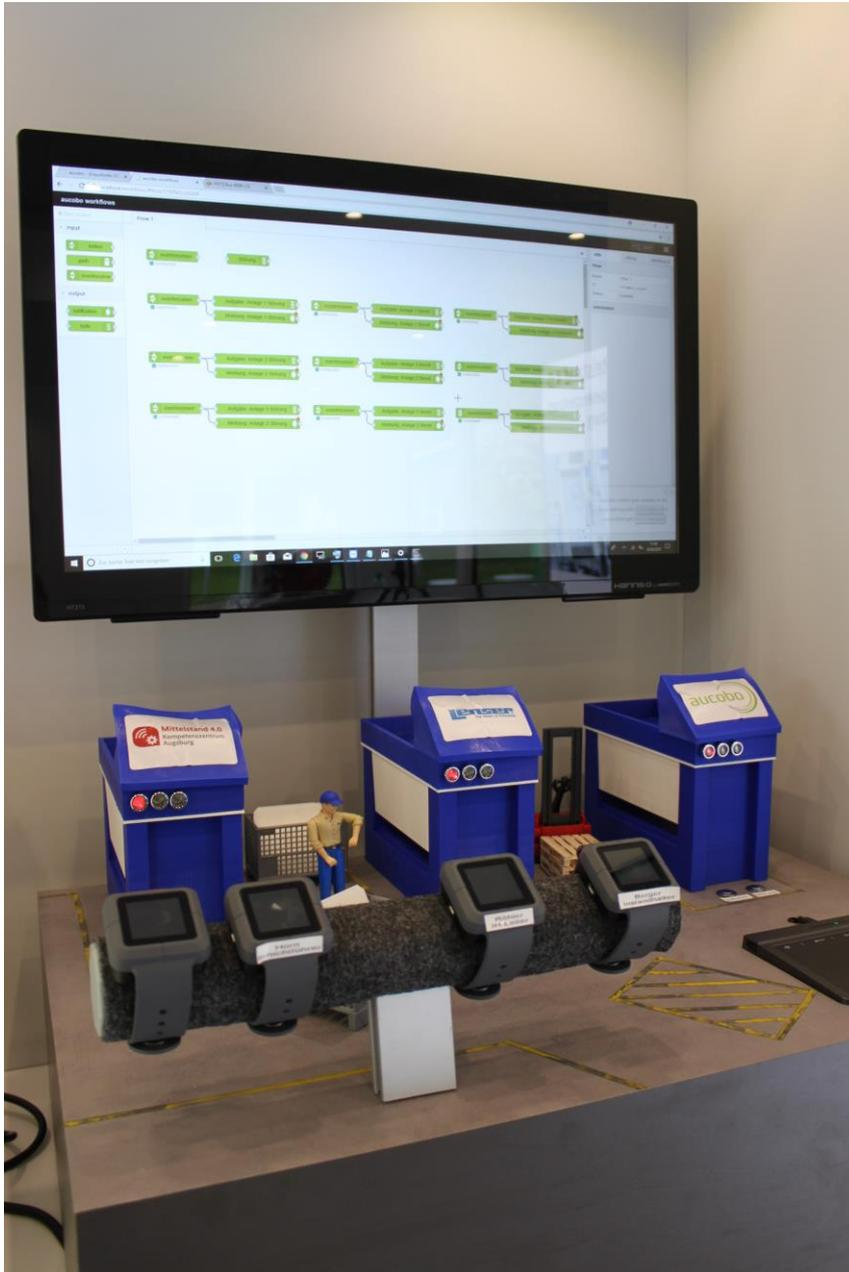
Über Smartwatches melden Maschinen Störungen und abgeschlossene Fertigungsprozesse, Mitarbeiter können schnell und flexibel reagieren.
