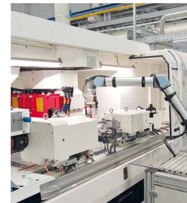
« Der Roboter entnimmt Bauteile aus der Vorrichtung (links) und bestückt die Werkzeugmaschine (rechts).
